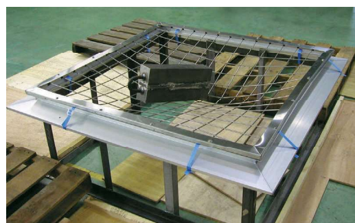
150cmの高さから落とした70kgの鉄柱も受け止めます。
